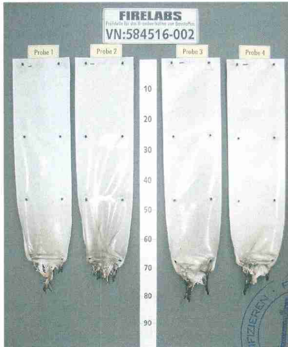
Bild 4 Aussehen der Probekörper nach dem Brandversuch
