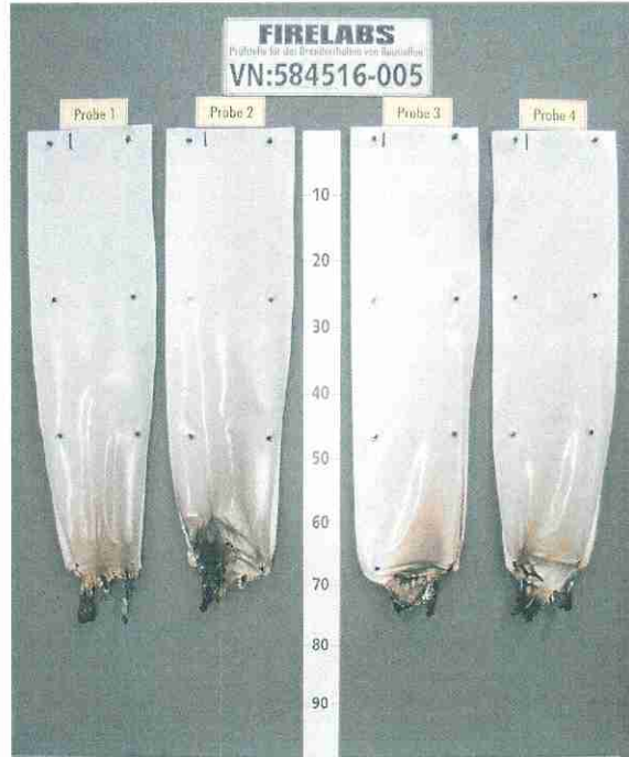
Bild 10 Aussehen der Probekörper nach dem Brandversuch
