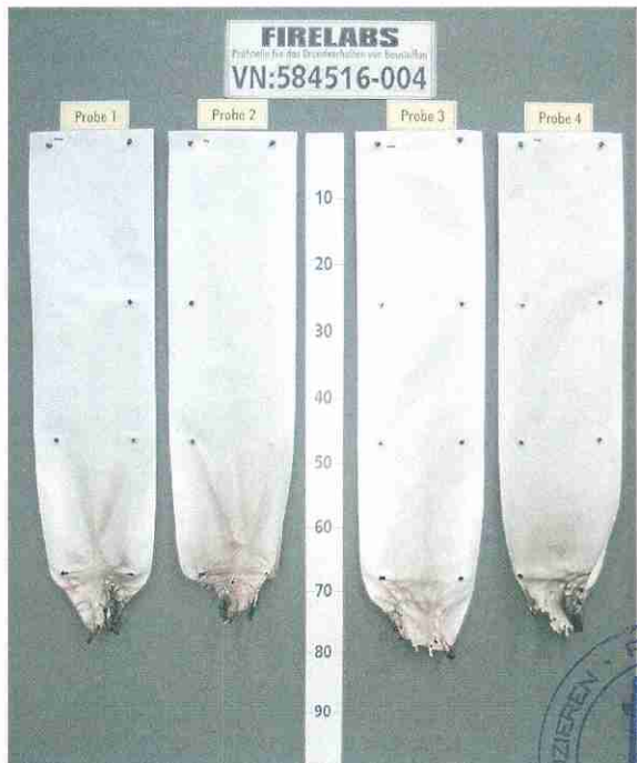
Bild 8 Aussehen der Probekörper nach dem Brandversuch
